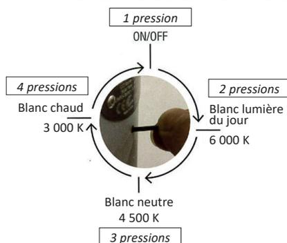
Appuyer sur le bouton pour activer le luminaire et faite défiler les températures de couleur à chaque pression sur celui-ci.
