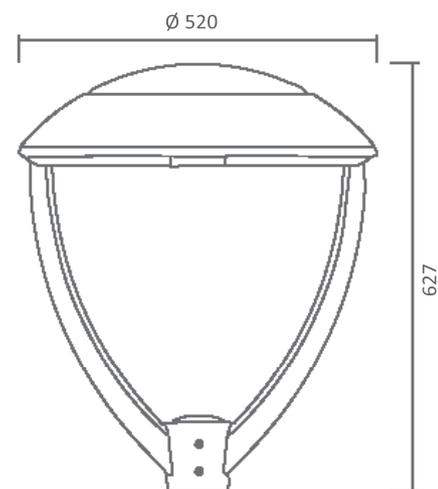
Adaptable sur tube Ø 60 mm
