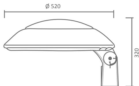
Adaptable sur tube Ø 60 mm
