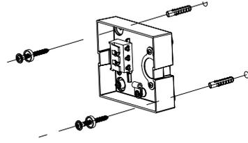
Fixer la base sur le mur en faisant passer les fils électriques à travers.
