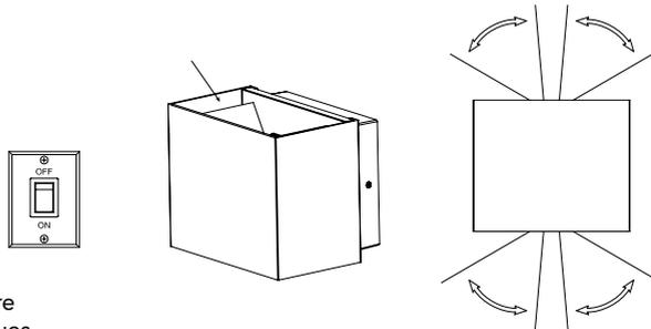
L'angle du faisceau peut être ajusté en orientant les plaques.
