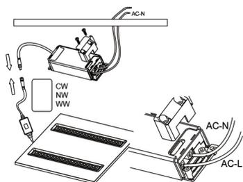
1. Raccordez la phase et le neutre au driver, puis branchez la dalle au driver en utilisant le connecteur prévu à cet effet. Enfin sélectionnez la température du «blanc» grâce au commutateur sur câble :
