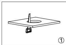
Ouvrez un trou approprié dans le plafond à la dimension exacte du luminaire.
