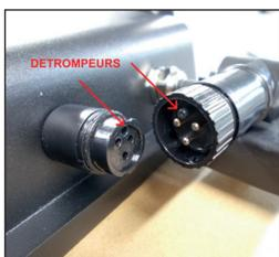
3. L'embase du projecteur et le détecteur possèdent un détrompeur. Alignez-les pour insérer le détecteur. Puis tourner l'écrou de verrouillage 1/4 de tour dans le sens horaire.
