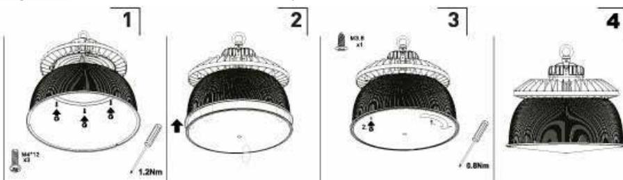
Installez le corps du diffuseur anti-éblouissement sur le luminaire avec les 3 vis fournies.
