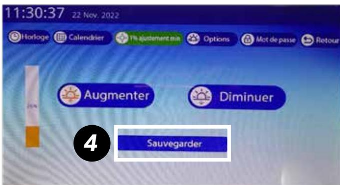
L'échelle affichée ici est une échelle relative. Le maximum correspond à 15% de la tension du secteur et le minimum à 4%.
