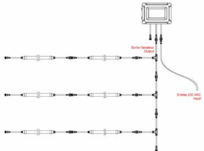
Charge maximale : 60 luminaires LED de 18W
